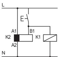
• 可控制連接至控制訊號終端B1的一個外部負載，如另一個繼電器線圈或計時器。
