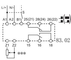
\*\*\* 類型83.02: 使用外部電位計調節 (10 kΩ - 0.25 W)。
