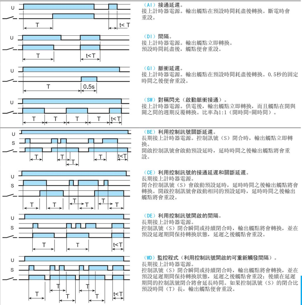
注意：計時功能必須在計時器斷電時設定。或對於83.02/52，在觸電模式選擇器處於「關閉」位置時設定。
